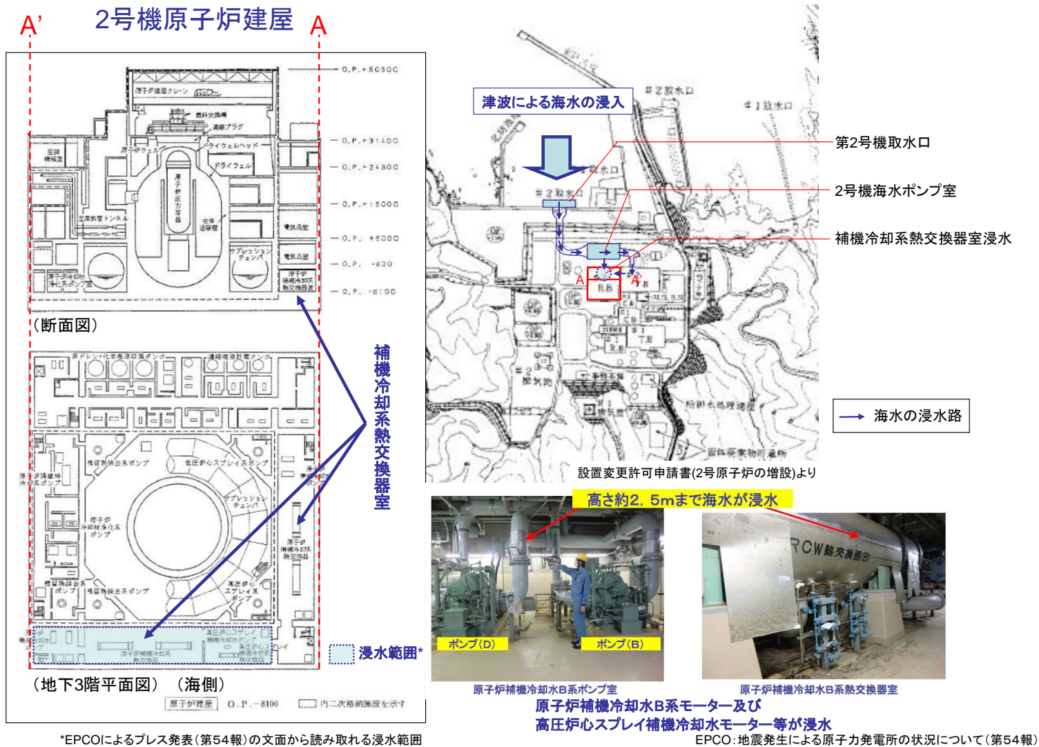
図 III-3-5(a) 女川原子力発電所の津波による補機冷却系熱交換器室の浸水状況(1)
