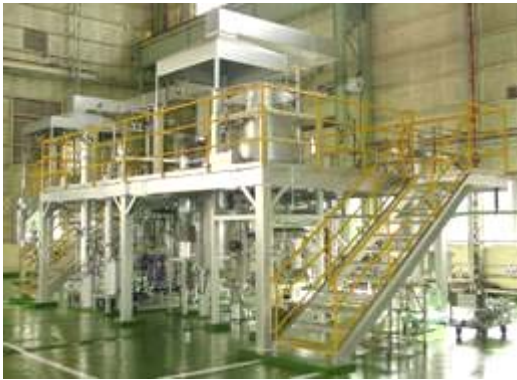
ガス化メタノール変換実証プラント「農林バイオマス1号機」
