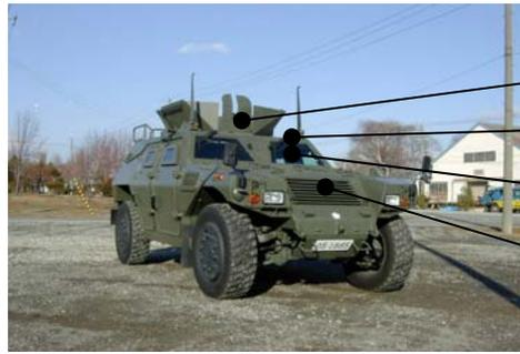
正面・背後からの射撃に対して射手を防護するための改修
