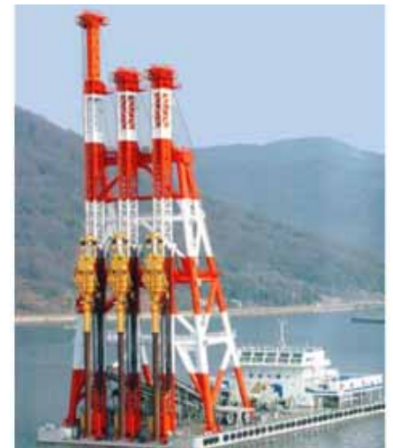
サンドコンパクション船(地盤改良に使用) 高さ = 78m
