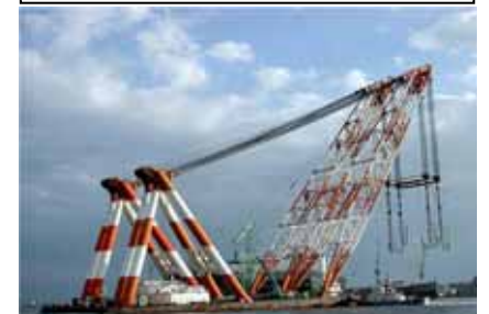
起重機船(ジャケット据付けに使用) 高さ=131m
