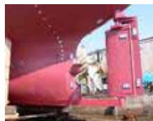
船尾バルブと二重反転プロペラ （推進効率の向上）
