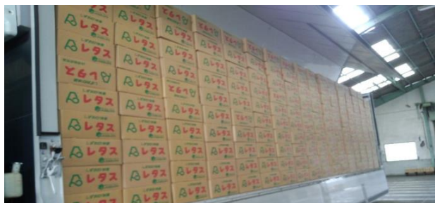
10トン車に、レタスのバラ積み1,200ケース分(1ケース7～10kg程度)のダンボールを、手積み・手卸している事例。
