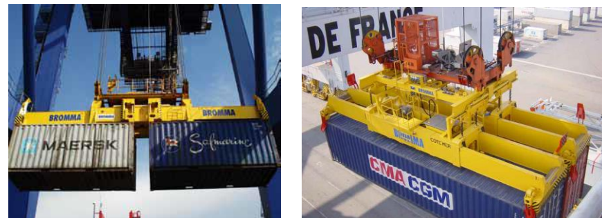
コンテナ2個吊りクレーン
