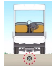
○電磁誘導線を敷設、実験車両を誘導
