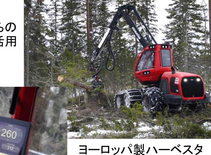
ヨーロッパ製ハーベスタ (立木を伐採し、丸太に 造材する機械)
