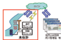
中小河川への水位計の普及促進のために水管理・国土保全局において開発した低コストな水位計のイメージ
