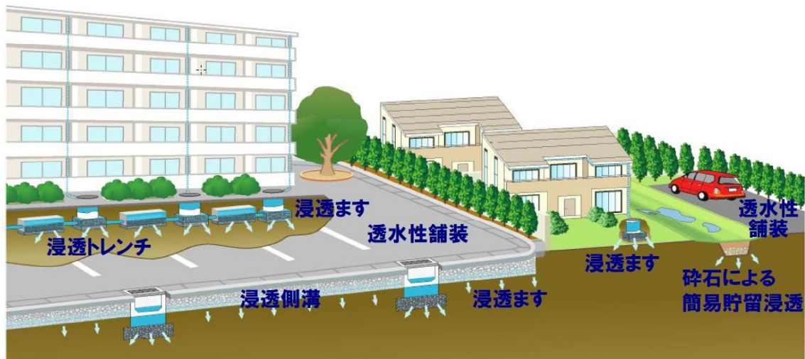
図 4-3 雨水浸透施設の設置のイメージ
