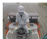
直線キープ可変施肥田植機
