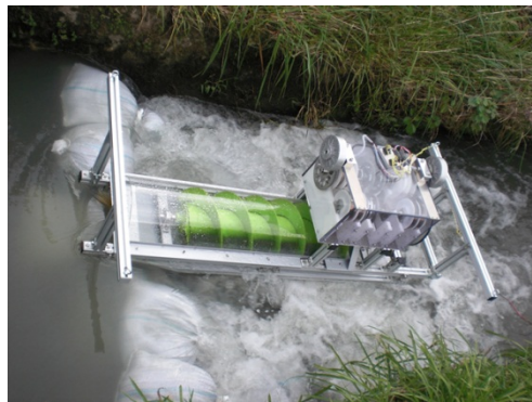
水力発電設備であって出力20kW未満のもの
