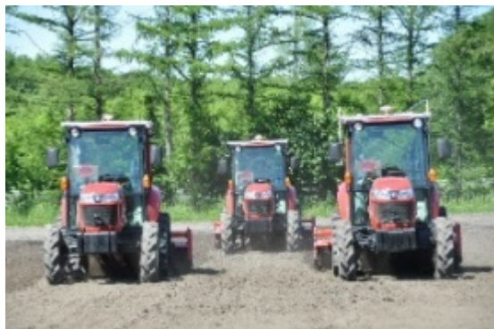
スマート農業の推進（GPSを利用した 無人トラクター）
