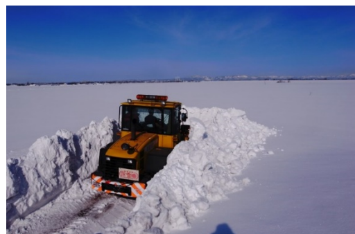
GPSガイダンスを使った除雪作業
