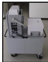
可搬型モニタリングポスト【15台】 （衛星系回線による通信機能付）
