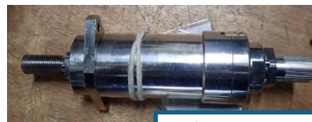
緊急離脱ボルト ガス発生剤の生産中止 →代替品の開発が必要
