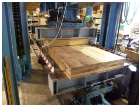
試作したCLT(スギ)の強度試験の様子(平成24年度)
