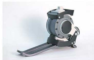
足首の機能を再現したロボット義足の試作機
