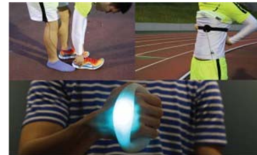
SMASH (Synchronization Media of Athletes and Spectator through Haptic) (慶應義塾大学大学院メディアデザイン研究科) 選手の体験を心音とプレイの触覚を観客に伝送し、感覚を共有するシステム。心音と選手のシュートやスマッシュの衝撃を触覚として観戦者の手元のデバイスに組み込まれた振動子を通して手のひらに提示し、「観る」だけの受動的な観戦から、プレイを「感じる」ことができる体験型の能動的な観戦を実現する。
