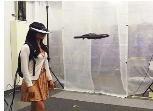
Flying Eyes/Flying Head (東京大学 暦本研究室) 自律飛行ヘリコプターを使って、体外離脱したような第三者視点の映像が撮影でき、自分の後ろ姿を確認しながらランニングするなど、トレーニングのサポートなどに応用が可能。
