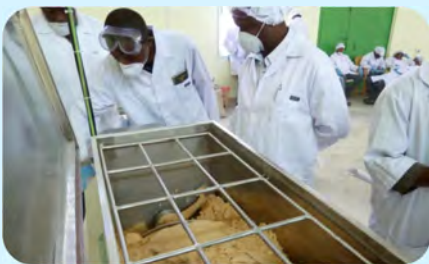
「KOKO Plus®」の製造工場内にある原料の混合機
