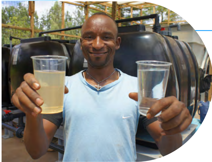
▲浄化する前の表流水(左)と、重力を利用した「緩速ろ過装置」で浄化した処理水(右)
