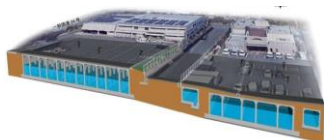
雨水貯留浸透施設の整備
