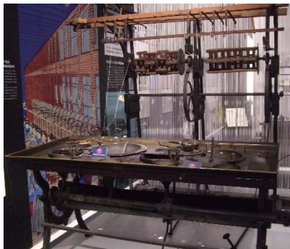
明治期の繰糸機 (繭から生糸を巻き取る機械)
