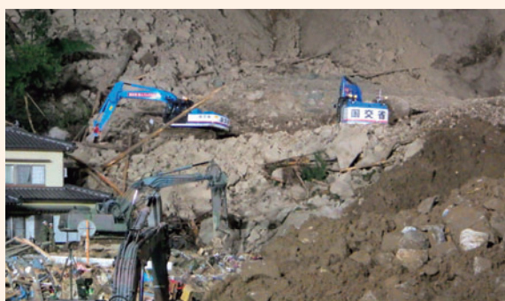
写真 特11 遠隔操作式バックホウによる搜索活動支援（平成30年大分県中津市土砂災害）
