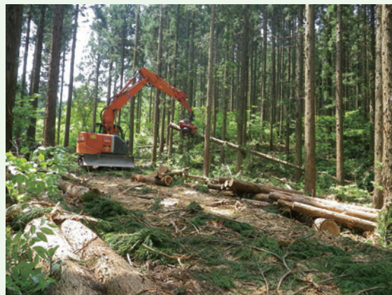
写真2-2-2 高性能林業機械による間伐の様子
