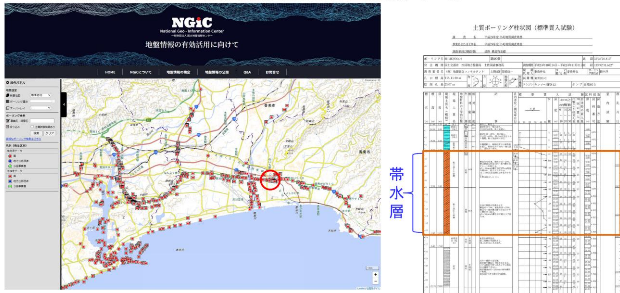
高知平野における地質(柱状図)情報の例 出典: 国土地盤情報データベース ( https://ngic.or.jp/ )
