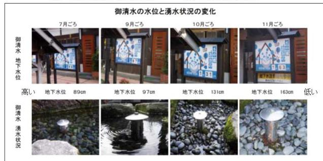
地下水位低下に伴う湧水の枯渇の例
