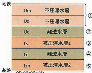
図 鳥取平野の地層のモデル
