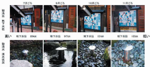
地下水位低下に伴う湧水の枯渇の例 出典：越前おの湧水文化再生計画
