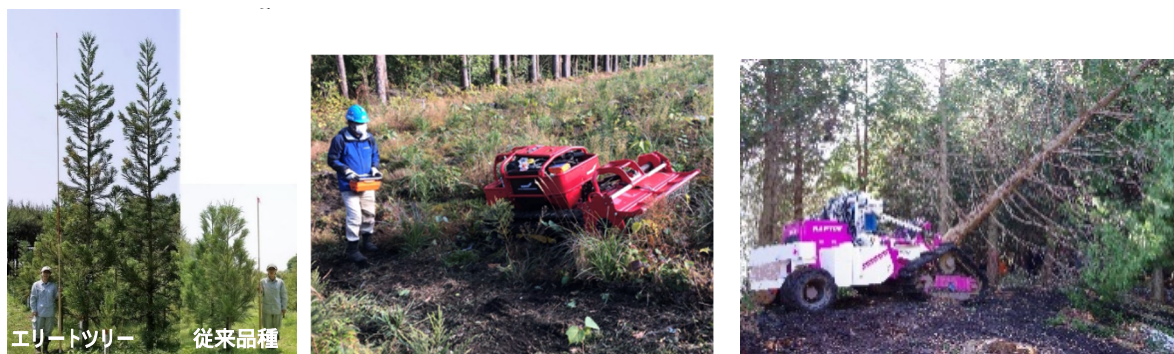
6 図 30 林業イノベーションを通じた林業作業の低コスト化・省力化の例 7 (左：エリートツリー等の導入、中：遠隔操作による下刈り、右：遠隔操作に 8 による伐採・搬出)
