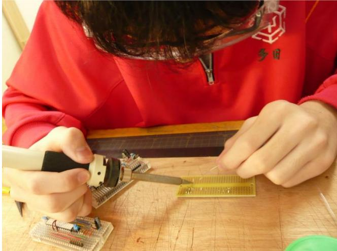
ブレッドボード上で組み上げた電子回路を、はんだづけしています。持ち運んでも部品が抜け落ちないために。
