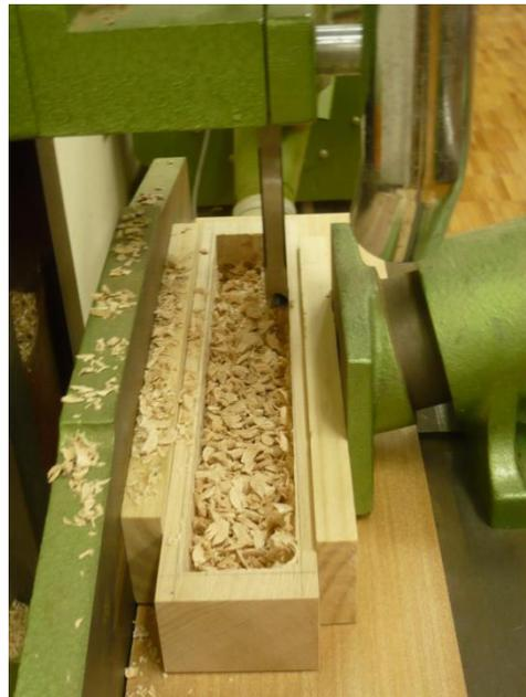
材料加工で使用した工作機器は、角のみ盤、卓上ボール盤、帯のこ盤、糸のこ盤、ベルトサンダ、オービダルサンダ、など。見た目や手触りの良さを重視して、板材ではなく、角材からの製作としたため、角のみ盤を多用しました。角のみ盤による加工は、想像を遙かに超えて体力・筋力・集中力を必要とするものでした。
