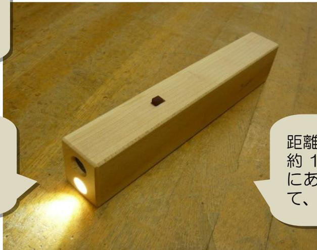
台座から外すと、傾きセンサが反応して、すぐにパワーLEDを点灯！
