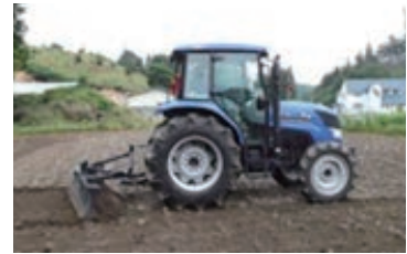
↑ 表土の削り取り作業
